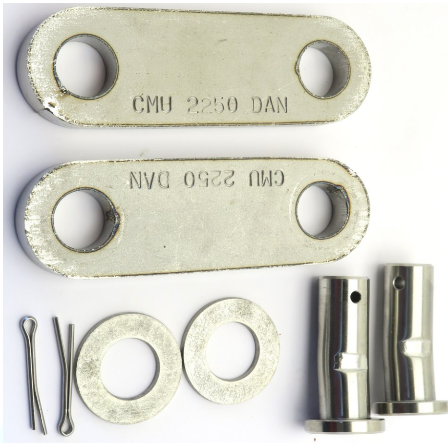
Aspect de la pièce 2 après essai.
